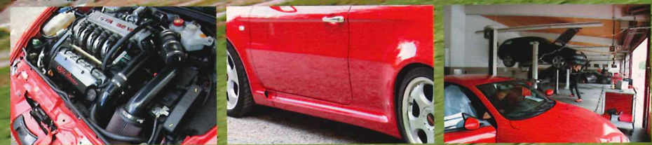
↓スーパーチャージャーを1基ポルトオンした3.2ℓV6エンジン。エンジンルームは手の入れる隙のないほどギチギチ ↓フロントは車高/減衰力調整式。リアは車高調整式となるサスペンション。ノーズヘビーを感じさせないセットだ ↓作業中のクルマがずらりと並ぶピット。こちらはフィアット/アルファ、そしてランチアが入庫することになる
