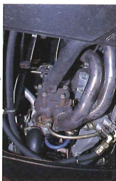
▶シュワイツァー製のターボは、エンジンルーム右側の前端に位置。純正のエキゾーストマニホールドを加工して組み付けていて、コストダウンを配慮した跡もうかがえる。
