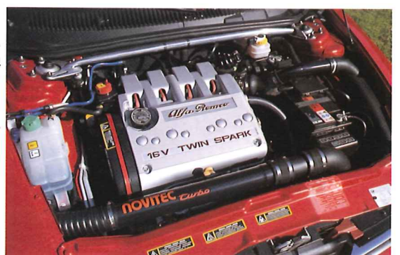
▶エンジンルームで目立つのは、ノヴィテックのターボシステムのパイピング。他は外観上も変更なく、大人しいもの。しかし、このエンジンが、ノーマル比53psアップの218psという最高出力を叩き出しているのだ。
